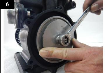
Tighten up the stud bolt.
